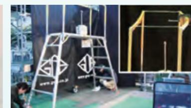
【水平荷重試験：静的荷重試験】
